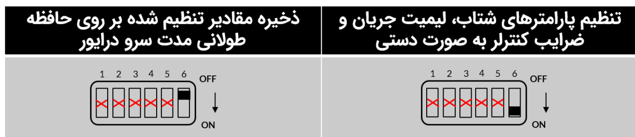
شکل ۲-۷: انتخاب تنظیم ضرایب به صورت دستی و ذخیره کردن آنها رو حافظه طولانی مدت سرو درایور
